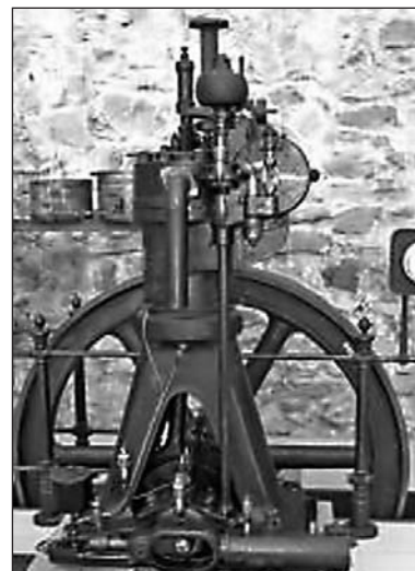
■ В 1896 г. Рудольф Дизель с гордостью представил готовый экземпляр своего «дееспособного» двигателя мощностью 20 л. с., который экспонируется в Машиностроительном музее в г. Аугсбург
